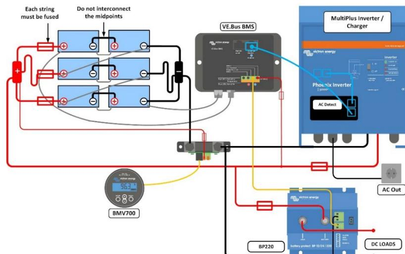
Nos batteries LFP sont équipées de fonctions d'équilibrage et de surveillance de cellules. Les câbles d'équilibrage/surveillance de cellules peuvent être raccordés en guirlande, et ils doivent être connectés à un système de gestion de batteries (BMS).
