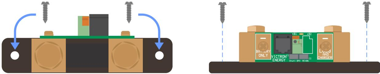
Vue de haut du shunt montrant les orifices de montage et vue latérale indiquant la méthode de montage.
