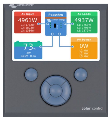
Color Control GX montrant une application PV
