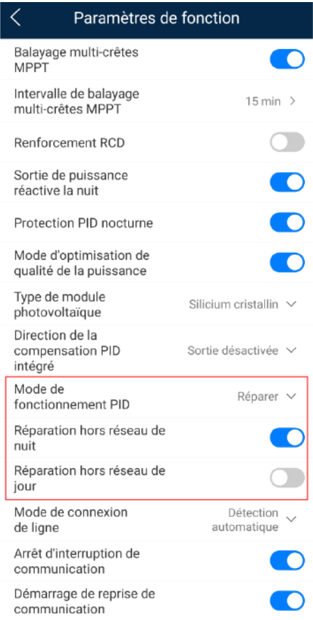
Figure 7-11 Récupération du PID intégré
